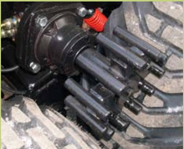
Hydraulinen 4-veto painorullalla. Rulla vapautuu automaattisesti kun vetoa ei tarvita.
